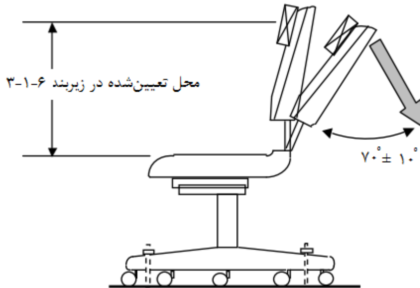
شکل ۱۰- اعمال نیرو برای آزمون استحکام سایر پشتی ها - استاتیک - صندلی نوع ۲
