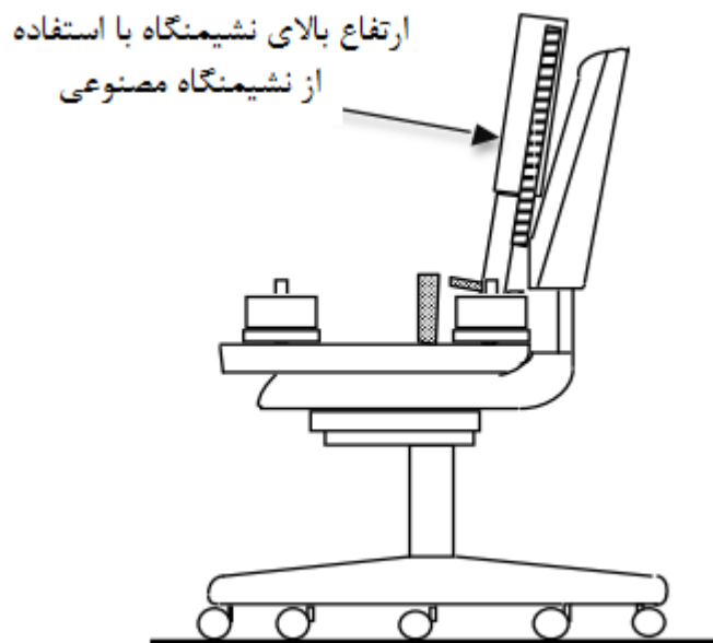
شکل ۳۳- تعیین ارتفاع در آزمون دوام پشتی - صندلی نوع ۱
