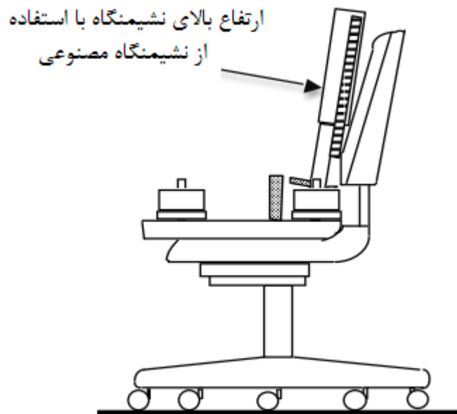
شکل ۴۰- تعیین ارتفاع در آزمون دوام پشتی - صندلی نوع ۲ و ۳
