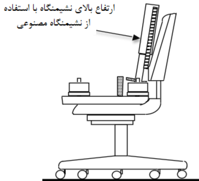
شکل ۴- تعیین ارتفاع در آزمون استحکام پشتی- استاتیک- صندلی نوع ۱ و ۲
